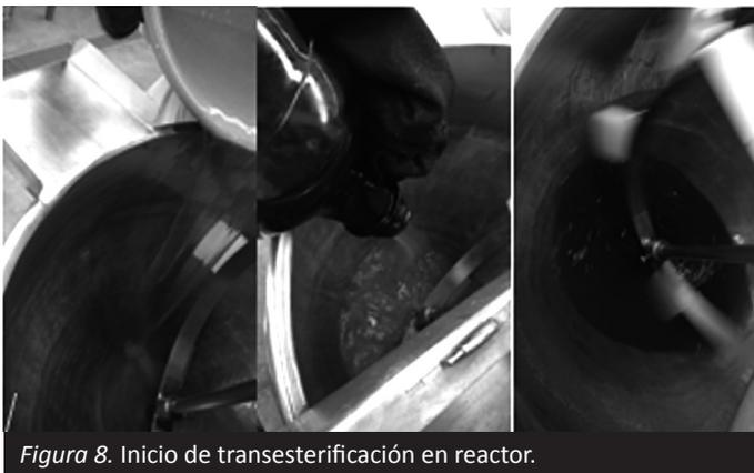
Figura 8. Inicio de transesterificación en reactor.
